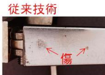
図 5 抵抗ろう付により発生した部品の傷
